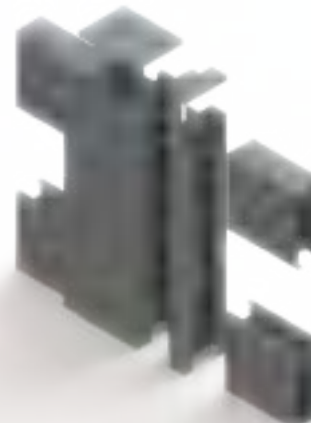
Détail poteau avec montant de dilatation
